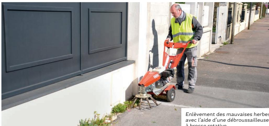
Enlèvement des mauvaises herbes avec l'aide d'une débroussailleuse à brosse rotative
