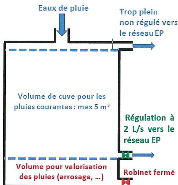
Ou mise en place de 2 cuves en série, la première pour la valorisation des pluies, la seconde pour le stockage/régulation
